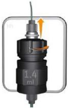
3. ミキサー上部のキャップから O リングを外します。
