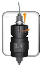
4. ミキサーチャンバー上部のキャップから O リングを外します。
