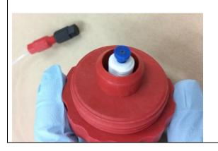
新タイプではチュービング加工なしで フェラル(写真中の青いパーツ)により密着 させる構造です。
