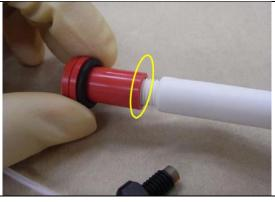
プランジャー部分のネジ締め (囲み部分) にゆるみがあると、液漏れが起こります。
