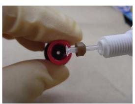
プランジャー内は、平らに加工したチュービングの先端を、プランジャーを締め付けることによりきつく密着させる構造になっています(旧タイプ)。
