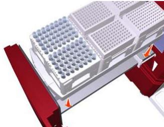
6、引き出しを開めると、自動的にカセット場所の認識が開始します。図のように異なる種類のカセットを一度にセットすることも可能です。正しく認識されたかどうかは、以下の手順で確認します。
