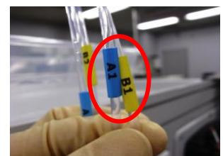
2、パージバルブにパージキットをしっかりと差し込み、パージバルブを反時計回りに約 3/4 回転して、シリンジのピストンをゆっくり引いて、エアが無くなるまで概ね 10~20 ml 分の超純水を引き入れます。
