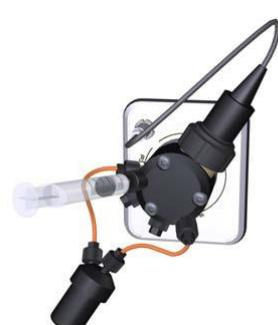
※ 推奨の pH 電極保護液（保存液）は、1 M 硝酸カリウムと pH 4 の溶液を等量混合した溶液です。
