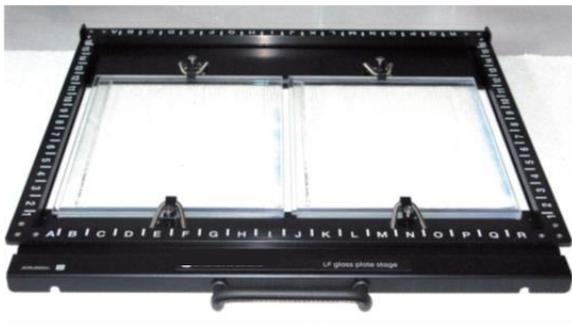
6. ガイドプレート位置ロックネジを回して、可動ステージをロックします。
