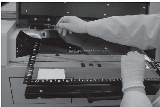
4. スキャナーのドアを開け、Fluor stage を枠の印字面が上になるように本体のステージホルダー上にセットし、奥まで（つきあたるまで）押し込んでください。
