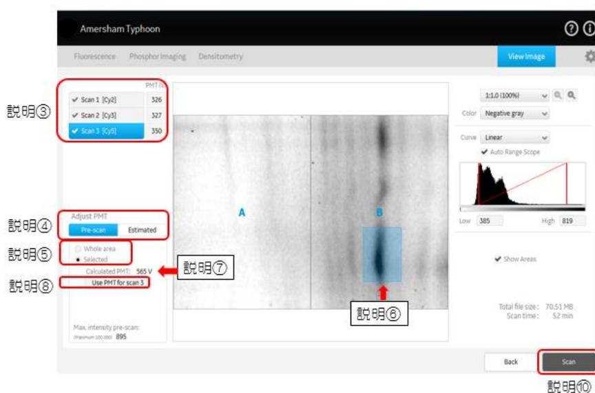
3. PMT 電圧値を設定するスキャン番号をクリックします（この例では Scan3 が選択されている）。
