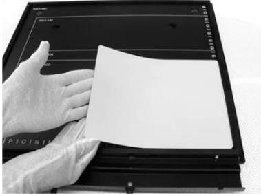
ストレージフォスファスクリーンは磁気を帯びており、それにより IP stage 所定の位置に保持されます。
