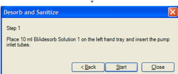
本体左側のランニング緩衝液用インレットチューブ2本を、BIAdesorb Solution 1ボトル(10ml)にセットする。**Start** をクリックする。所要時間8分程度。
