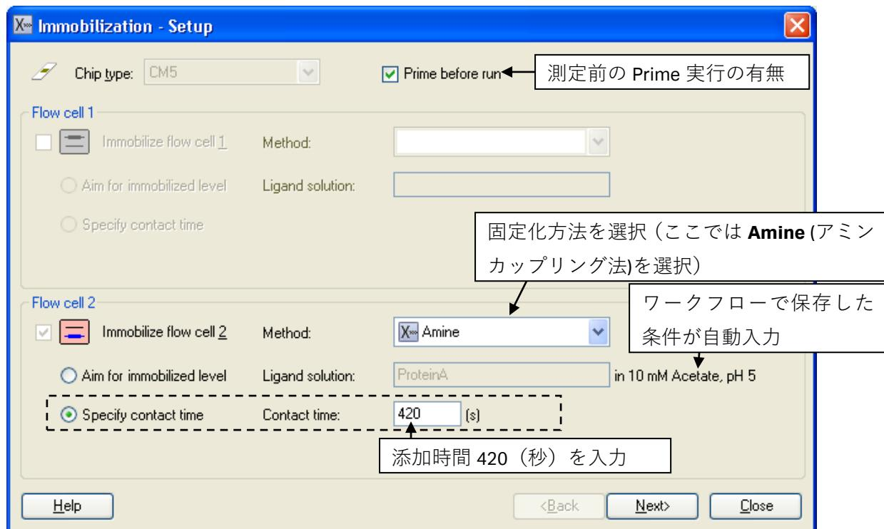
ワークフローで実施する固定化は、フローセル 1 がリファレンスセル、フローセル 2 がリガンド固定化セルとして設定されている。活性化およびブロッキング時間は 7 分間である。
