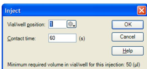
**Vial/well position:** の
