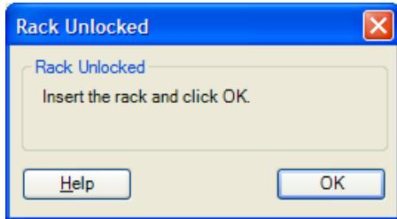
ロックが解除される。装置右上の“**rack locked**”のランプが消えてから、サンプルラックを取り出す。ラックにサンプルをセットし、ラックを装置に戻す。OKをクリックする。
