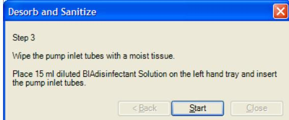
本体左側のランニング緩衝液用インレットチューブ2本を、希釈した BIAdisinfectant Solution (原液 1.5ml + MilliQ 水 20ml) ボトルにセットする。**Start** をクリックする。所要時間23分程度。
