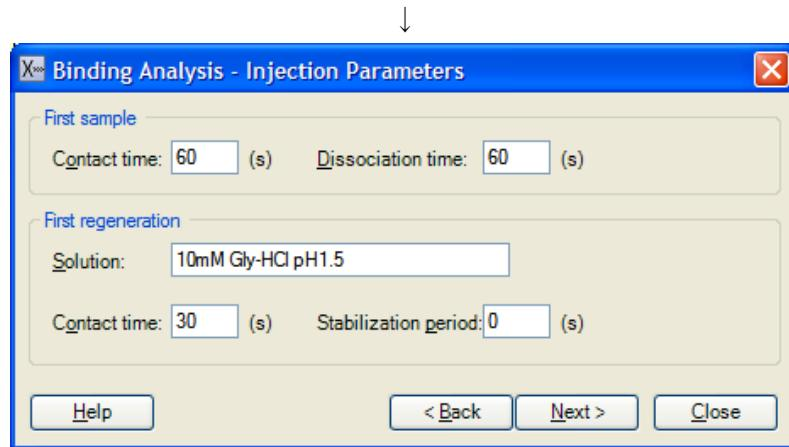
Injection Parameters ダイアログが表示される。ワークフローからウィザードで条件を検討し、決定した場合は、自動入力されている。
