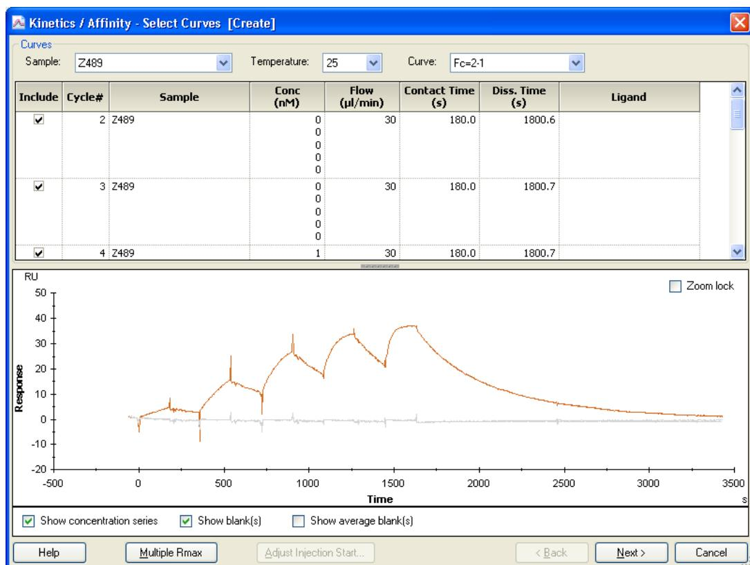
同一アナライト名のセンサーグラムが重ね書き表示される。複数のアナライトについて同時測定している場合は、**Sample:**右側の  をクリックし、解析したいアナライトを選択する。その中から、必要に応じて、センサーグラムの抽出を行う。補足 3-12.を参照する。
