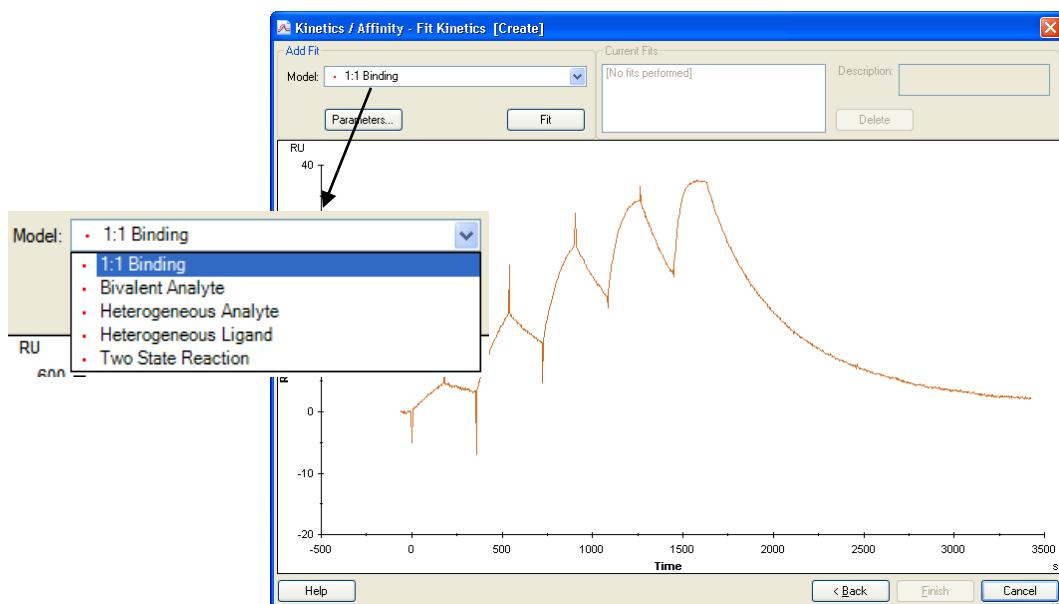
**Model:**でフィッティングに採用する反応モデルを選択する、をクリックすると、全ての反応モデルが表示される。反応様式が不明な場合は、1:1 Bindingを選択する。反応モデルについては、補足3-14.を参照する。
