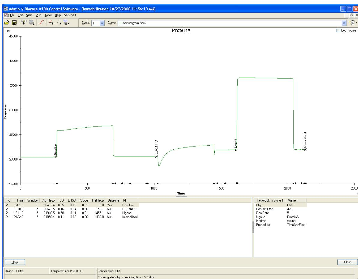
固定化が終了するとシステムは **Standby** 状態になる。測定データは入力したファイル名で自動保存される。**Immobilization Results** ダイアログが表示される。
