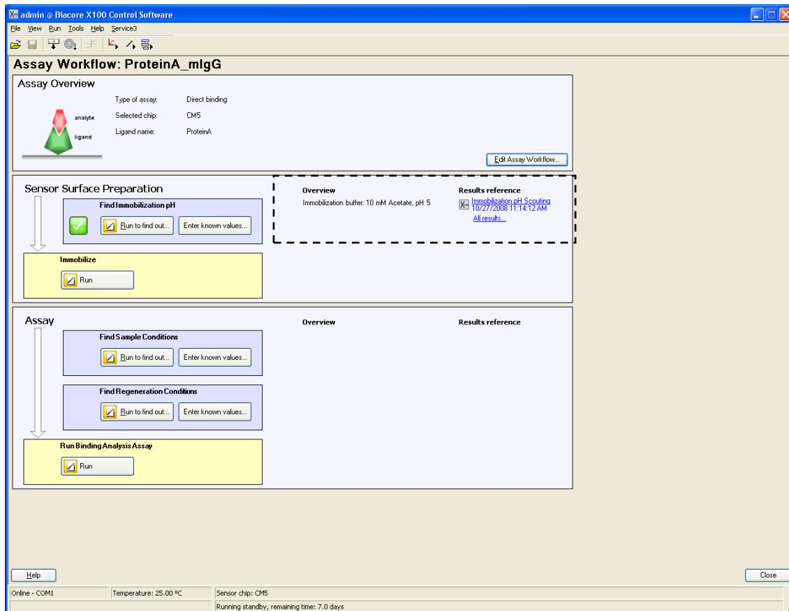
条件検討が終了すると、ワークフローシートの、**Find Immobilization pH** に (  ) が入る。 **Overview** にリガンドの調製条件が表示され、**Results reference** で、**Find Immobilization pH** で実行した測定結果ファイルが表示される。ファイル名をクリックすると、測定結果ファイルを開くことができる。複数のファイルがある場合には、**All results...** をクリックし、ファイルの確認を行う。
