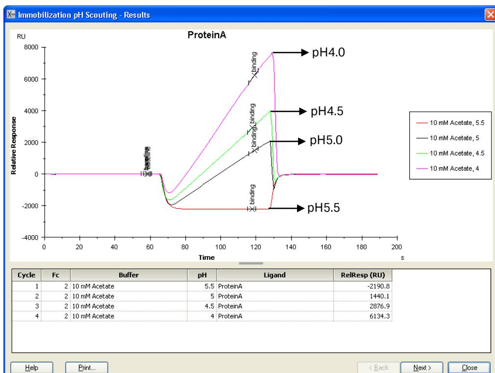
各緩衝液添加時のセンサーグラムが重ね書きで表示される。濃縮効果が確認できる最も高い pH 条件で固定化を行う。(上記の場合、pH5.0 を採用する。)
