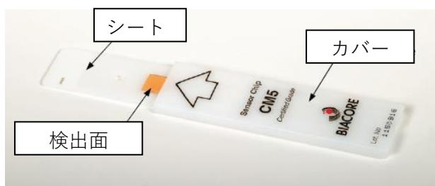
ピンセットを用いてシートを抜き出し、緩衝液に浸して保存する。
