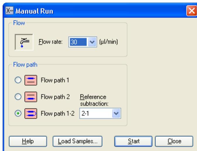
流速は 30 $\mu$ l/min、Flow path は 1-2、Reference subtraction は 2-1 を設定する。測定前にサンプルをセットする場合は、Load Samples...をクリックし、サンプルラックのロックを解除する。ラックにサンプルをセットし、装置に戻して、再びロックする。
