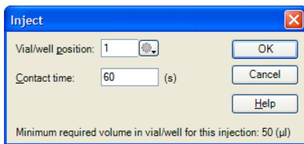
Contact time: にサンプル添加時間(秒)を入力すると、必要量がダイアログ下部に表示される。OKをクリックする。
