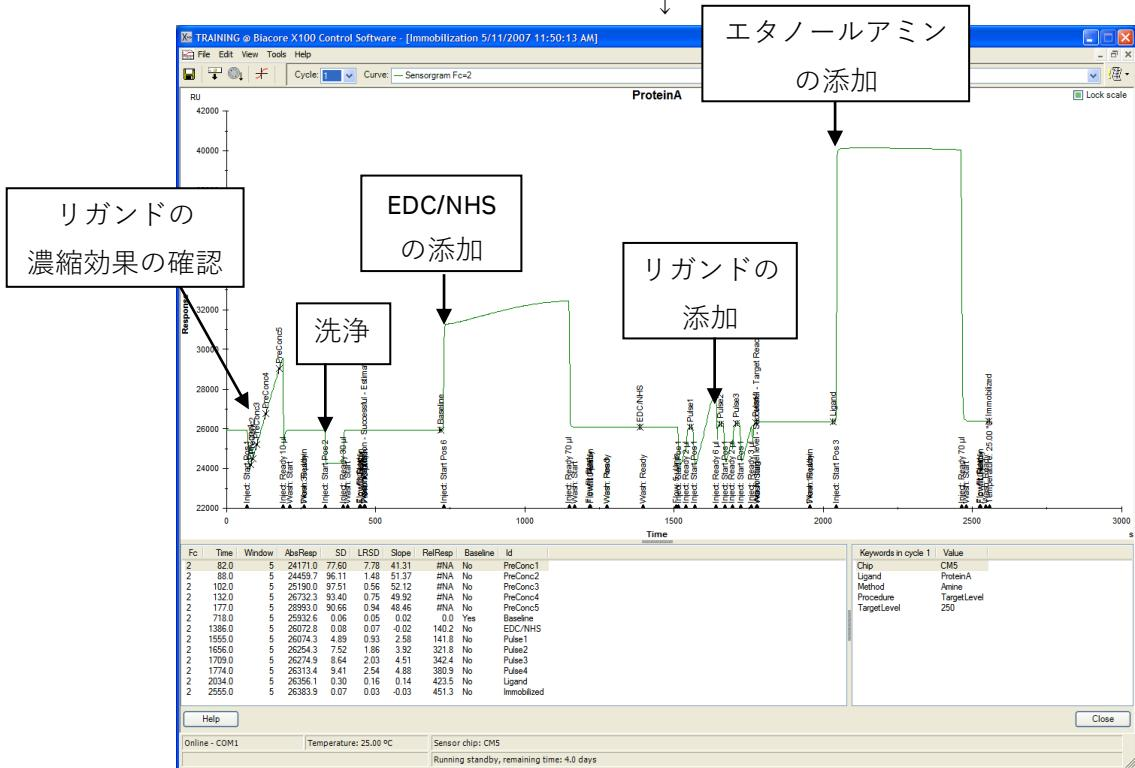
注意) **Aim for immobilized level** を選択すると、固定化の前に、リガンドの濃縮効果の確認とチップ表面の洗浄を行う。
