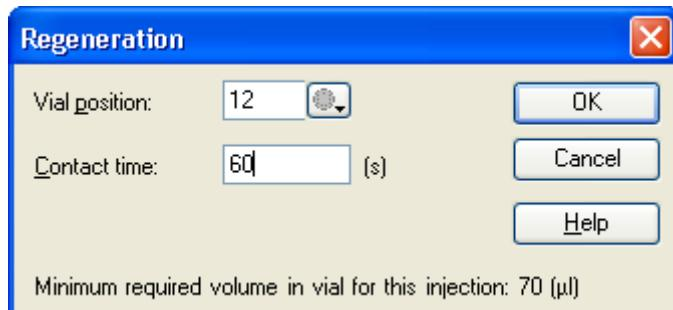
再生溶液のセット位置を選択、添加時間 (s) を入力し、**OK** をクリックする。
