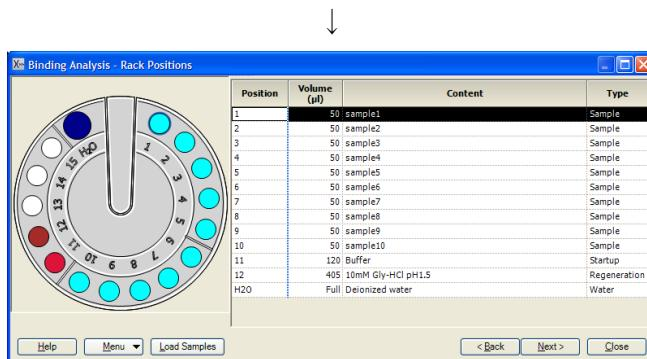
**Rack Positions** ダイアログが表示される。テーブルに従いサンプルをラックにセットする。
