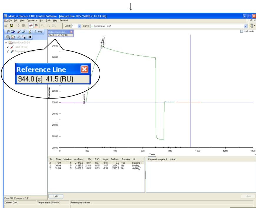
再生溶液添加後に、リファレンスラインの縦軸を左ボタンのクリック & ドラッグで移動し、再生後のアナライト残存量を確認する。
