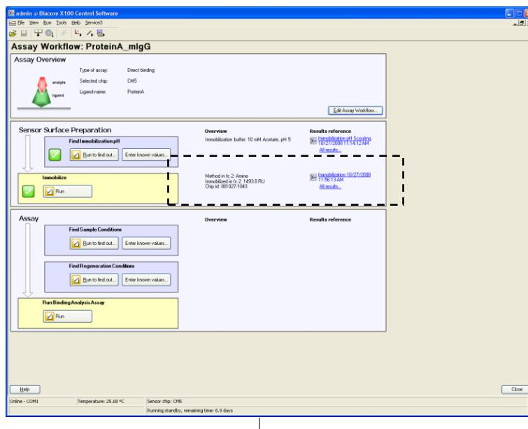
ワークフローシートの、**Immobilize** に (✓) が入る。Overview にリガンドの固定化方法、固定化量等が表示される。Results reference に、固定化の結果ファイルが表示される。
