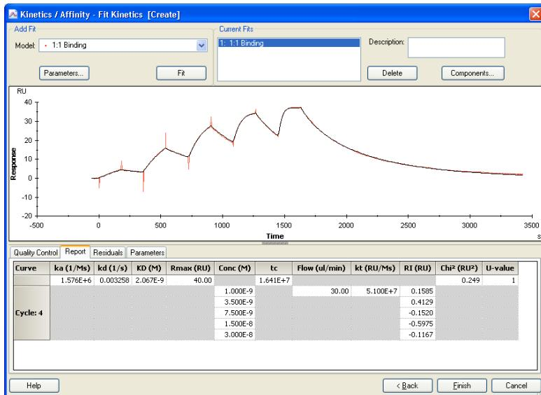
反応モデルを変更し再解析する場合は、**Finish** をクリックせず、**Add Fit** ボックスの **Model:** 右側の をクリックし、新しい反応モデルを選択する。**Fit** をクリックする。
