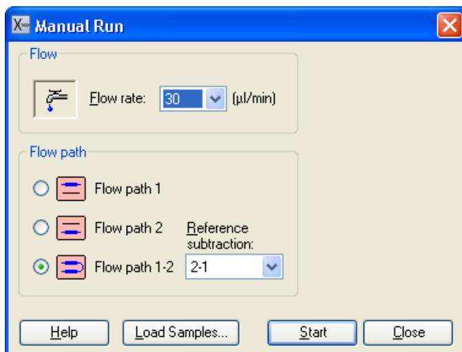
流速は 30ul/min、Flow path は 1-2、Reference subtraction は 2-1 を選択する。測定前にサンプルをセットする場合は、Load Samples...をクリックし、サンプルラックのロックを解除する。ラックにサンプルをセットし、装置に戻して、再びロックする。
