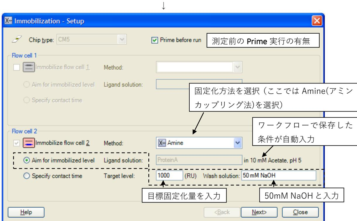
ワークフローで実施する固定化は、フローセル 1 がリファレンスセル、フローセル 2 がリガンド固定化セルと設定されている。活性化およびブロッキング時間は 7 分間である。
