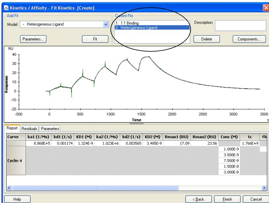
解析したすべての結果は、履歴として、**Current Fits** ボックスに残る。
