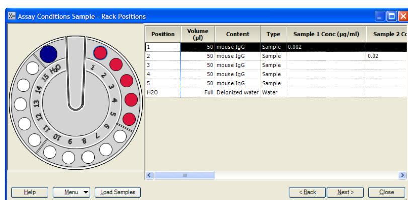
**Rack Positions** ダイアログが表示される。テーブルに従いアナライトをラックにセットする。**Next>**をクリックする。
