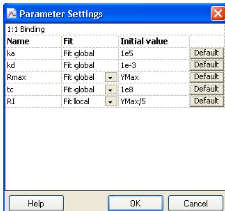
経時的なリガンドの活性低下や、マルチサイクル法において、再生の不十分さが原因で、全センサーグラムにおいて、Rmax を同一パラメータとみなせない場合、Rmax の行の Fit カラムの ▾ をクリックし、Fit local を選択する。
