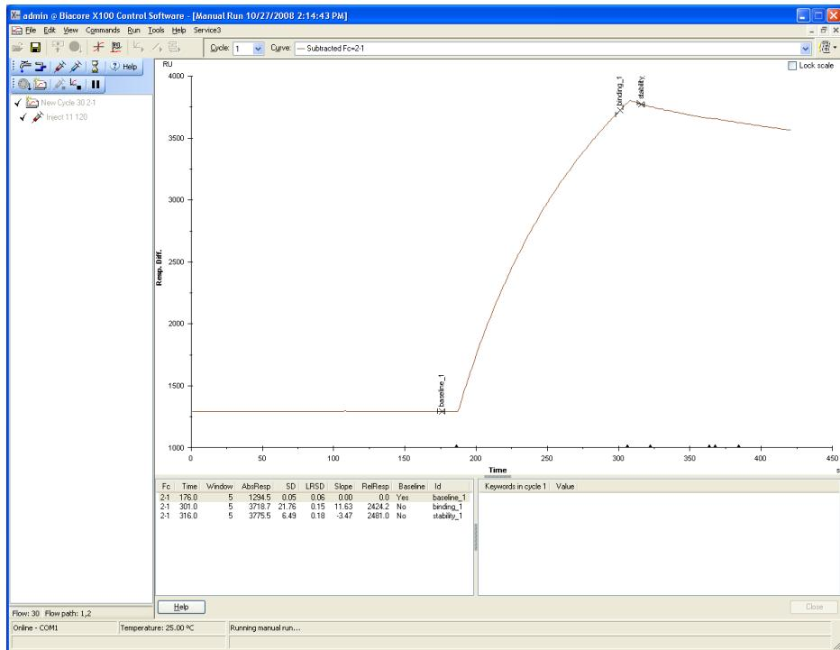
Fc=2-1 の差し引きのセンサーグラムを表示させる。特異的結合が見られれば、アナライト添加後、センサーグラムは上昇する。
