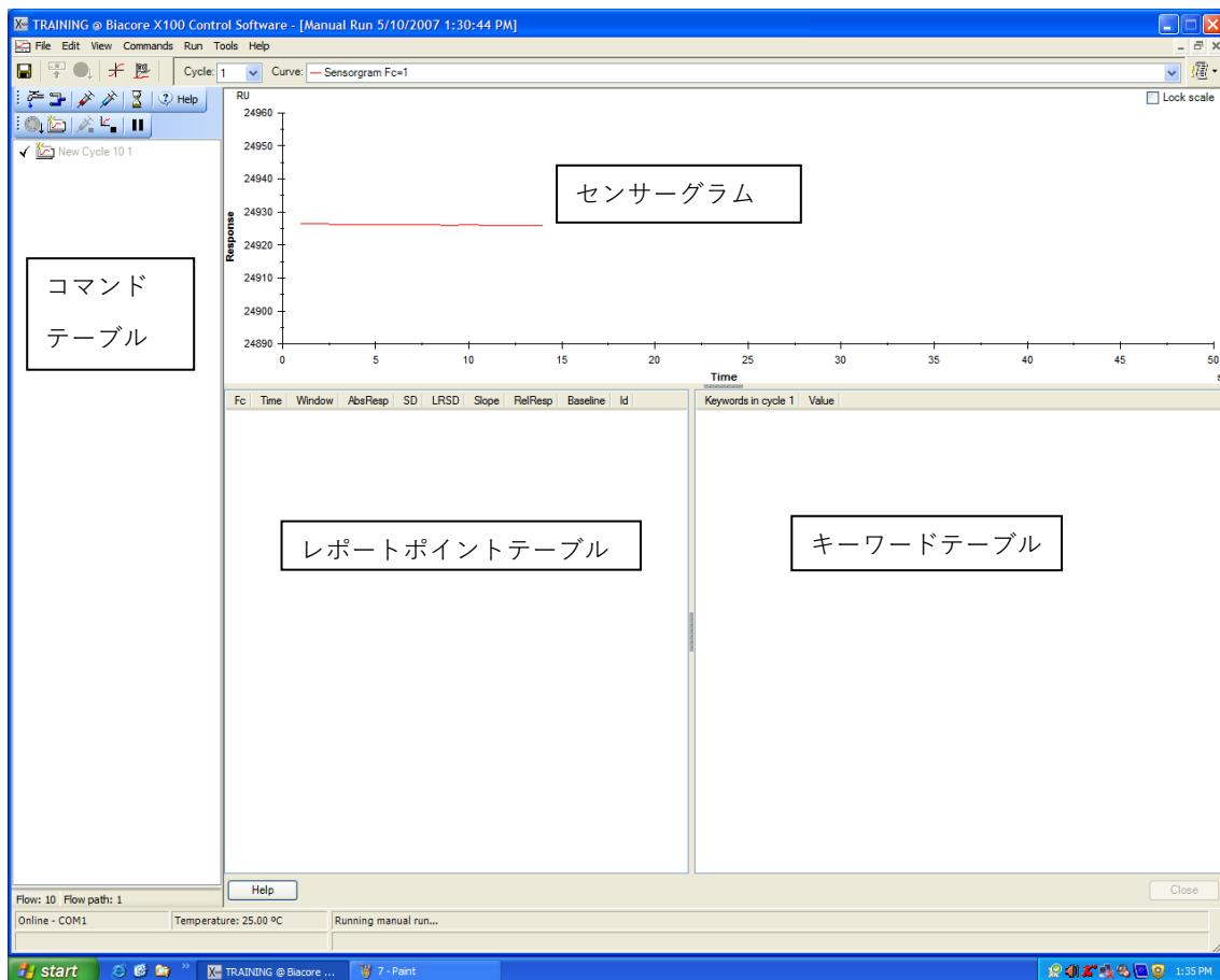
センサーグラムが表示され、測定が開始する。
