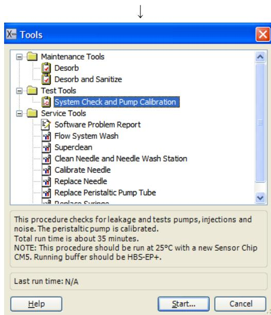
**Test Tools** → **System Check and Pump Calibration** を選択して **Start...** をクリックする。
