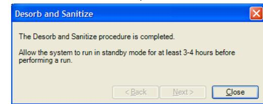
ステップ4終了後、システムは自動的に**Standby**状態になる。**Standby**状態で3～4時間放置するか、**Prime**を3回実施する。**Close**をクリックし終了する。
