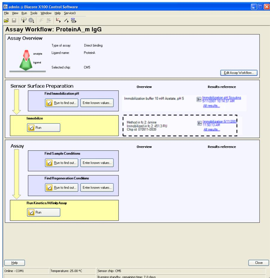
ワークフローシートの、**Immobilize** に ( ) が入る。**Overview** にリガンドの固定化方法、固定化量等が表示される。**Results reference** に、固定化の結果ファイルが表示される。
