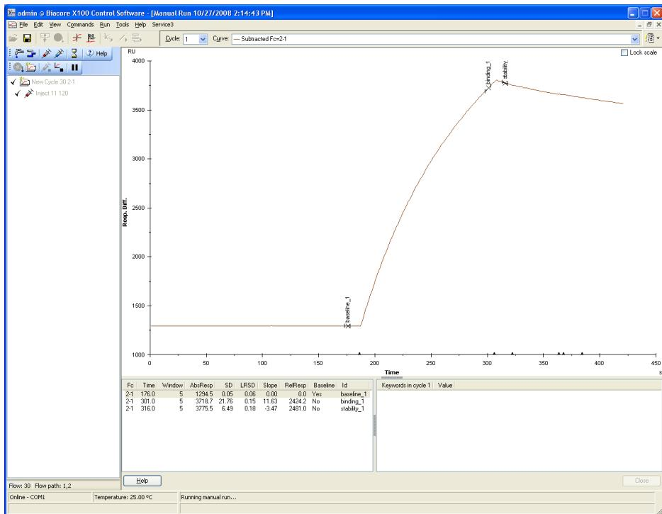
Fc=2-1 の差し引きのセンサー グラムを表示させる。特異的結合が見られれば、サンプル添加後のセンサー グラムは上昇する。
