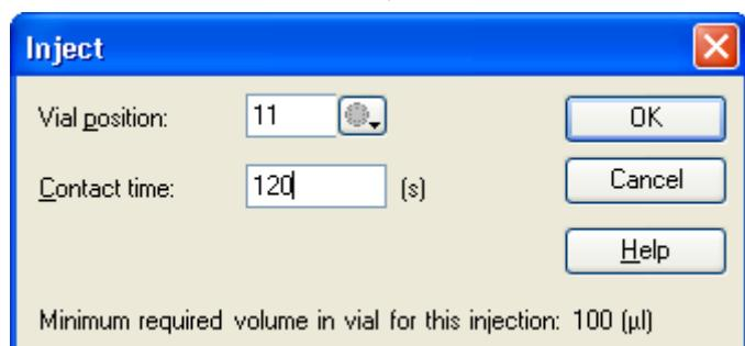
**Contact time:** にアナライト添加時間（通常 60 秒～120 秒）を入力すると、必要量がダイアログ下部に表示される。相互作用測定の条件検討の詳細は、IV- i . (実験を始める前に G ページ) を参照。
