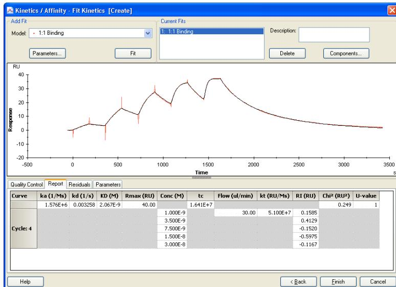
解析パラメータ (Rmax, RI) の解析設定条件を変更し再解析する場合は、**Add Fit** ボックスの **Parameters** をクリックする。
