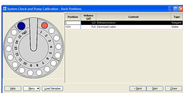
BIAtest Solution を、1.5 ml プラスチックバイアルに 123μl 分注してポジション 1 にセットする。また、ポジション H2O に MilliQ 水を 4ml セットし、**Start** をクリックする。
