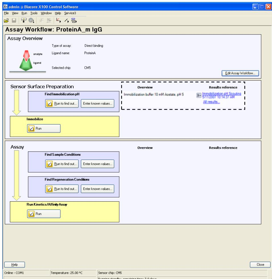
条件検討が終了すると、ワークフローシートの、**Find Immobilization pH** に (  ) が入る。 **Overview** にリガンドの調製条件が表示され、**Results reference** で、**Find Immobilization pH** で実行した測定結果ファイルが表示される。ファイル名をクリックすると、測定結果ファイルを開くことができる。複数のファイルがある場合には、**All results...** をクリックし、ファイルの確認を行う。
