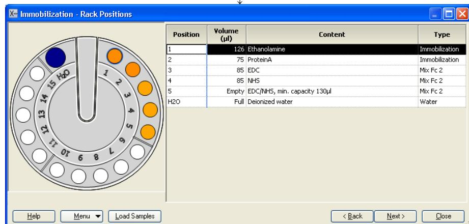
**Rack Positions** ダイアログが表示される。テーブルに従い必要サンプルをラックにセットする。
