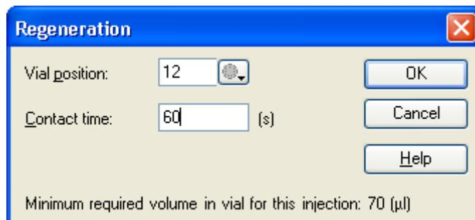
再生溶液のセット位置を選択、添加時間 (s) を入力し、OK をクリックする。
