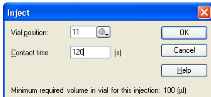
**Contact time:** にアナライト添加時間（通常 60 秒～120 秒）を入力すると、必要量がダイアログ下部に表示される。バイアルに必要量を準備し、ラックにセットする。相互作用測定の条件検討の詳細は、IV- i . (実験を始める前に G ページ) を参照。
