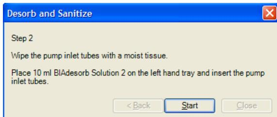
本体左側のランニング緩衝液用インレットチューブ2本を、BIAdesorb Solution 2 ボトル(10ml)にセットする。**Start** をクリックする。所要時間7分程度。
