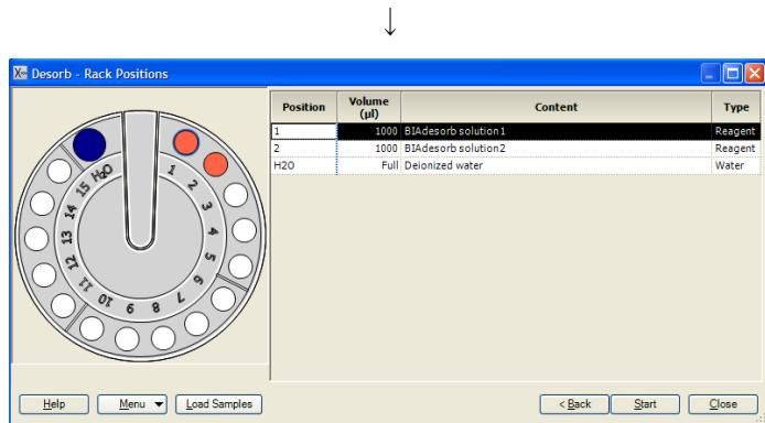
BIAdesorb solution 1 および、BIAdesorb solution 2 を、それぞれ 1.5ml プラスチックバイアルに 1000 μl 分注して指定のポジションにセットする。15mm プラスチックバイアルに MilliQ 水を 4ml 入れ、ポジション H2O にセットする。Start をクリックする。
