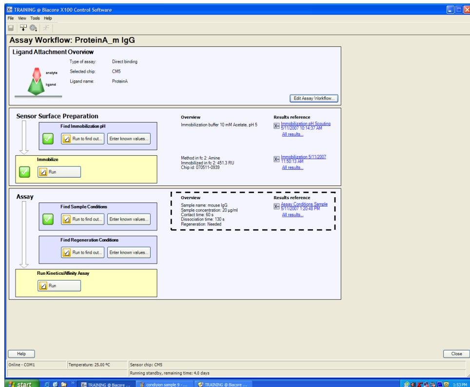
ワークフローシートの、**Assay** → **Find Sample Conditions** の **Run to find out...** に (  ) が入る。**Overview** にアナライト添加時間と解離時間、最大濃度等が表示される。
