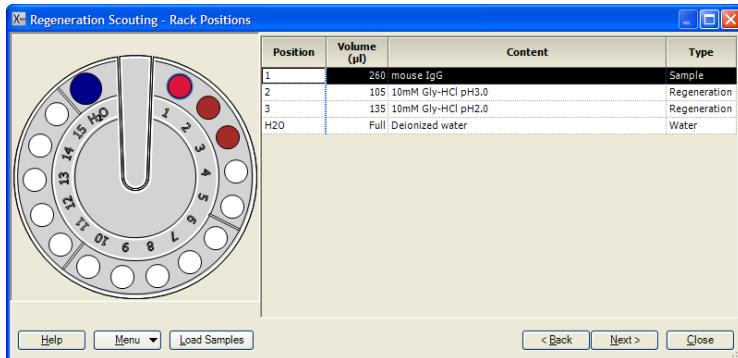
**Rack Positions** ダイアログが表示される。テーブルに従いサンプルをラックにセットする。
