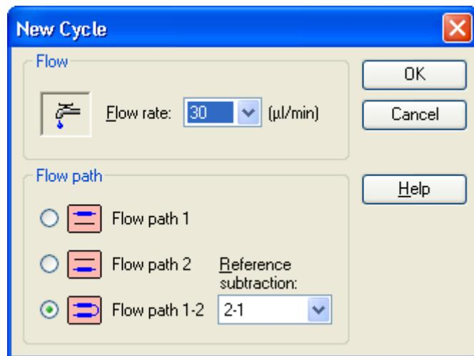
流速、Flow path の設定を確認後、**OK** をクリックする。
