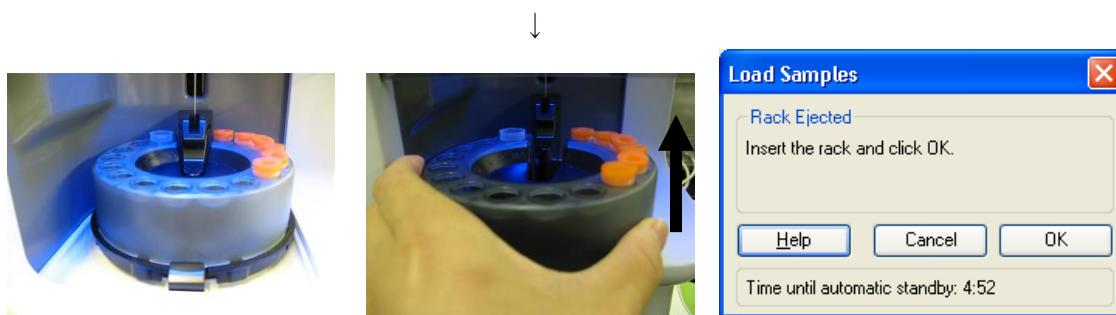
画面上に **Rack Ejected** ダイアログが表示される。ラックをセット後、**OK** をクリックする。
