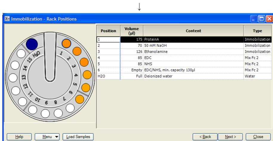
**Rack Positions** ダイアログが表示される。テーブルに従い必要サンプルをラックにセットする。
