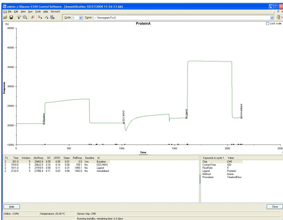
固定化が終了すると、システムは **Standby** 状態になる。**Standby** の終了方法は、2-1-4. (22 ページ) を参照する。**Immobilization Results** ダイアログが表示される。
